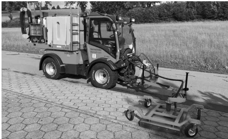
Das Unkrautvernichtungssystem kann an den vorhandenen Geräteträger montiert werden.
