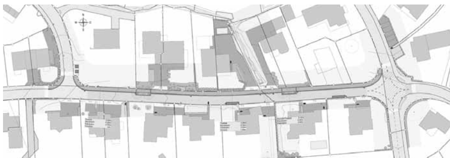
Sanierungsprojekt mit horizontalen Versätzen.
