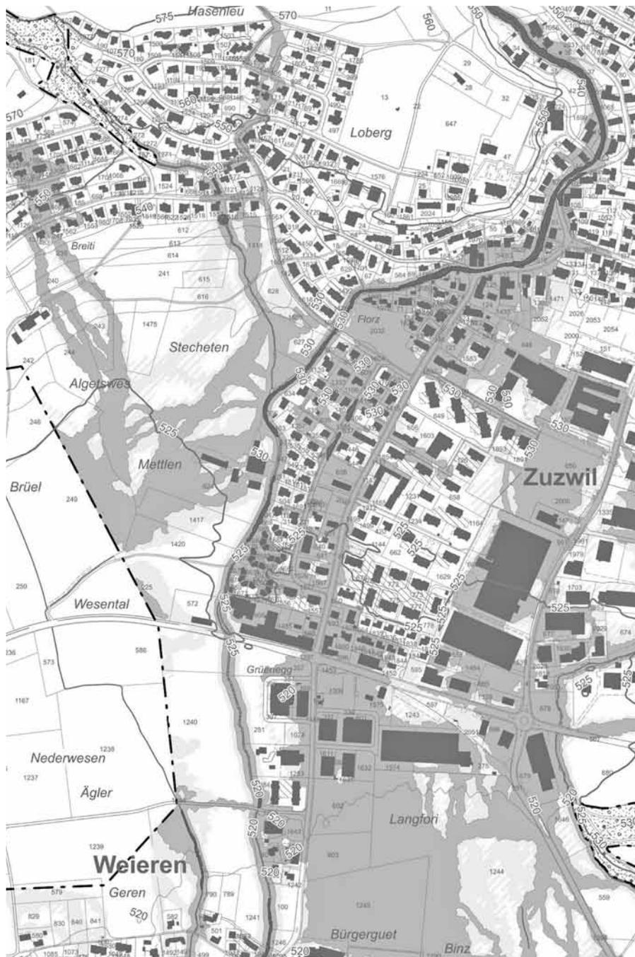
Gemäss Gefahrenkarte sind bei einem Hochwasserereignis grosse Teile der Dörfer Weieren und Zuzwil betroffen. Entsprechend wichtig ist es, möglichst zeitnah am Dorfbach Hochwasserschutzmassnahmen zu treffen. Nur so kann die Gefahr von grossen Schäden reduziert werden.
